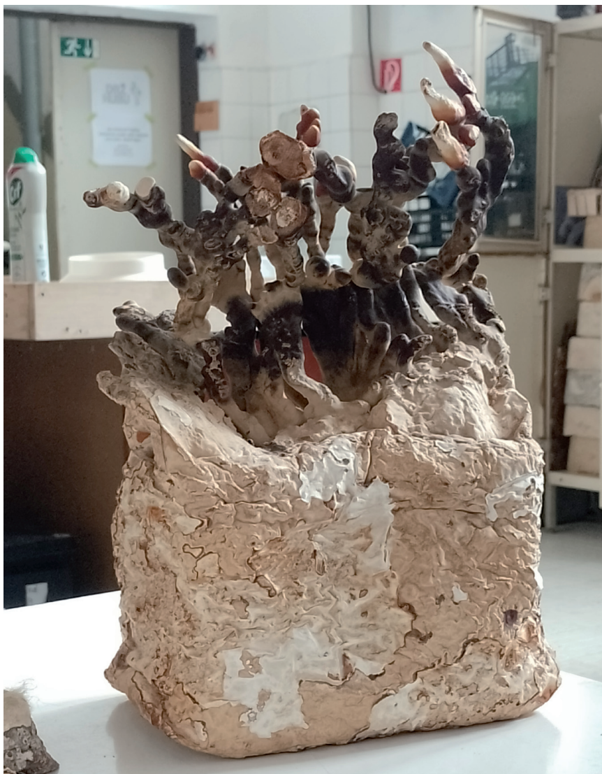
Mycéliová tvárnica s vyrastenými húbami
